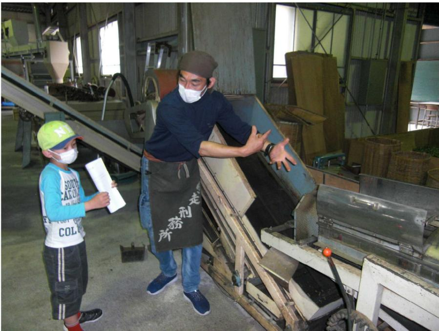
ベルトコンベアーにのせられた葉を蒸す機械
